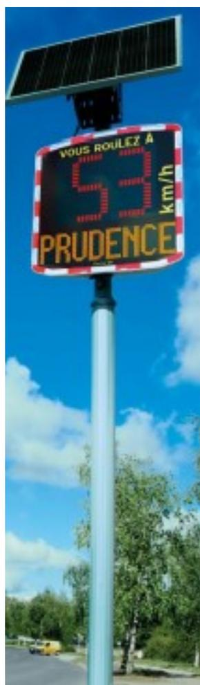
Le radar pédagogique est un matériel qui permet d'afficher la vitesse des conducteurs qui passent dans le village. Ce principe de radar consiste à informer les automobilistes de la vitesse à laquelle ils se déplacent et également quand la vitesse maximale autorisée est dépassée. Un message de prudence est alors affiché.
